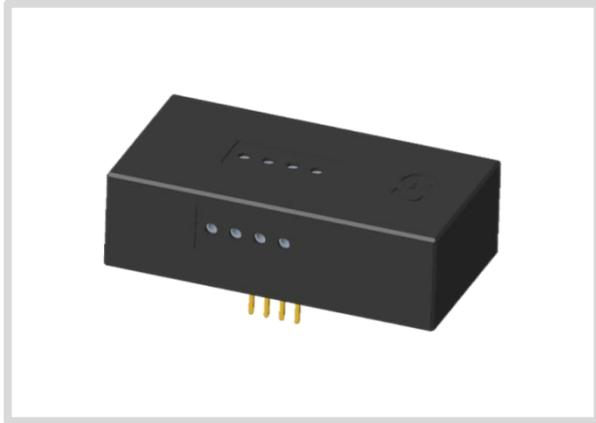
DSH06M-M40K-JS 是采用 NDIR 红外吸收检测原理，将先进光路、精密电路与智能化软件相结合，形成一款通用型红外冷媒传感器模组。DSH06M-M40K-JS 采用单光源、双通道探测器，实现了空间上双光路参比补偿，微处理器进行信号采集、处理和输出，实现了环境温度补偿，修正了原理上非线性关系，并具有多种输出形式。具有 NDIR 产品特有的良好选择性，高灵敏度，无氧气依赖性，寿命长等特点。DSH06M-M40K-JS 可广泛应用于暖通制冷新风控制、可安装于智能楼宇、通风系统、汽车等应用场合。
